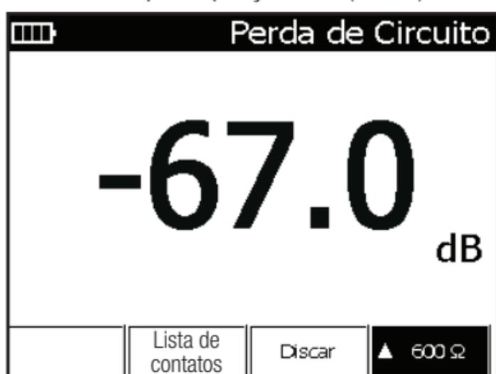
3. Ative o sinal de teste discando de um badisco externo ou com menu de discagem interna do instrumento de teste Sidekick® Plus.
