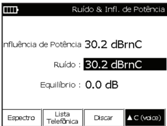
*Nota: Uma vez conectado à linha silenciosa, o usuário pode alternar entre as medições de ruído e influência de potência. O Sidekick® Plus manterá a conexão até que os cabos de prova sejam desligados ou o usuário gire o botão para outro posição.*
