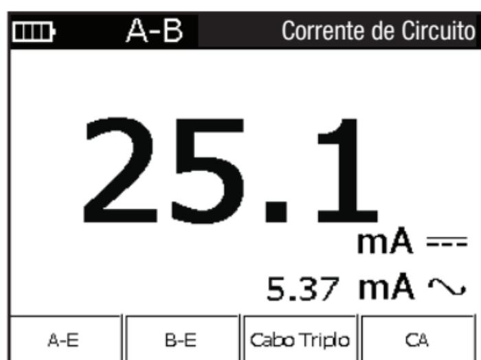
*Nota: A corrente de B-terra deve ser, pelo menos 1,5 vezes a corrente de circuito da A-B. Se não for, pode haver uma falha de aterramento na central. Não deve haver nenhuma corrente de A-terra.*
