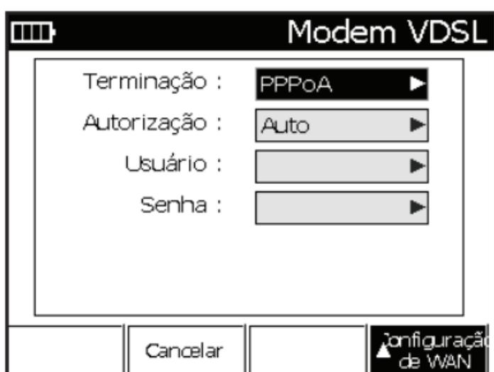
Esta é a tela que permitirá o nível PPP (protocolo ponto a ponto) de teste. O nível PPP de teste requer que as seguintes informações sejam inseridas na tela de configuração PPP:
