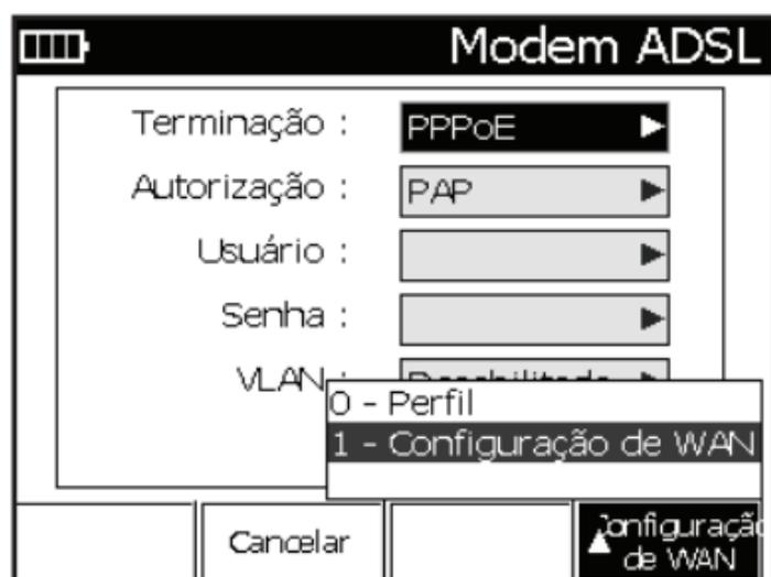
Use as teclas de seta para cima (**2**) e para baixo (**8**) para selecionar o parâmetro de configuração a ser alterado. Para fazer uma alteração, pressione a tecla de seta direita (**6**) para mostrar a janela de destaque de seleção.
