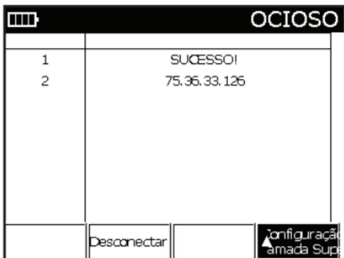
Os parâmetros de configuração WAN são usados na autenticação. A configuração WAN deve ser feita antes do teste de modem.
