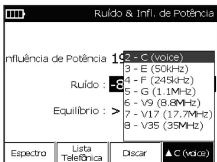
O filtro “C (voz)” é um filtro de mensagem C para banda de voz de 300 Hz a 3 kHz.
