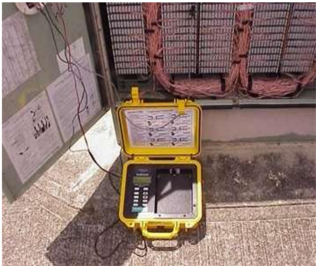
Raccorder l'émetteur dans un central, une armoire d'interconnexion ou une borne de manière à « **émettre la tonalité vers l'abonné** »
