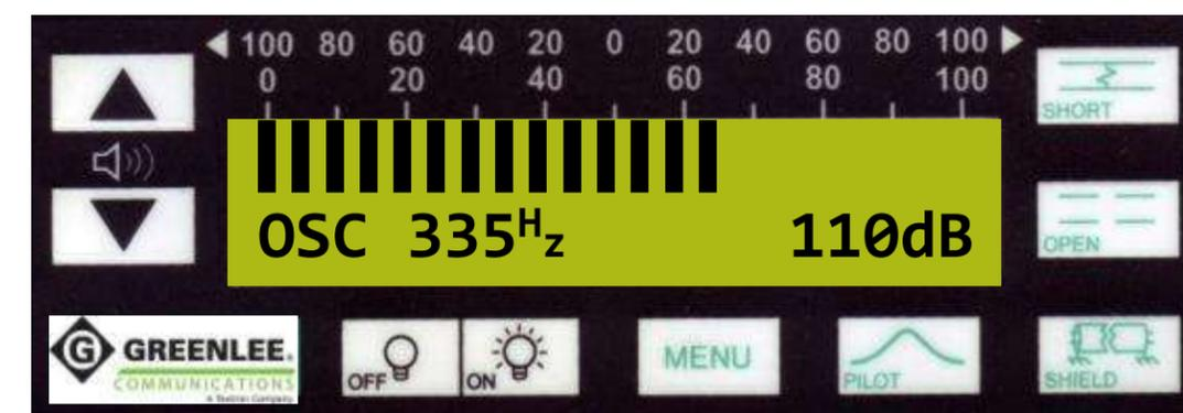
**ATTENTION : Lors de la localisation par tonalité d'un blindage ouvert en mode Coil (bobine) seulement, ne pas toucher le panneau arrière du récepteur car cela peut mettre la tonalité à la terre!**
