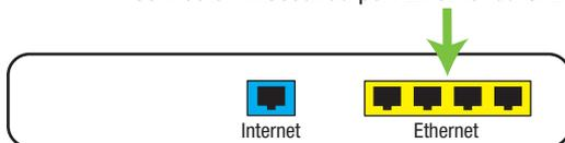
*Remarque : si la connexion est effectuée sur un port CPE différent, AirScout ne pourra pas effectuer le test en utilisant le CPE.*
