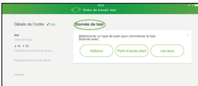
2. Si « Point d'accès client » ou « Les deux » est sélectionné, on doit connecter le maître AirScout au CPE et fournir le SSID et le mot de passe pour le CPE. Pour des motifs de sécurité, AirScout n'enregistrera pas les SSID ou les mots de passe saisis.
