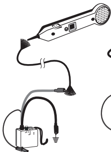
Figura 4a. Rastreamento de cabos
