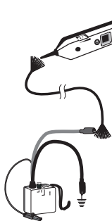
Figura 4a. Rastreo de cables
